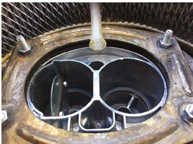
Figura 1. Ubicación de la alimentación del HHO.
